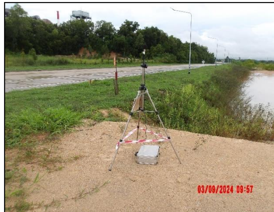
รูปที่ 3.8 ตรวจวัดระดับเสียง 15 นาที บริเวณ เครื่องจักร/เครื่องมือ ซึ่งเป็นแหล่งกำเนิดเสียงในการก่อสร้าง (N4)
