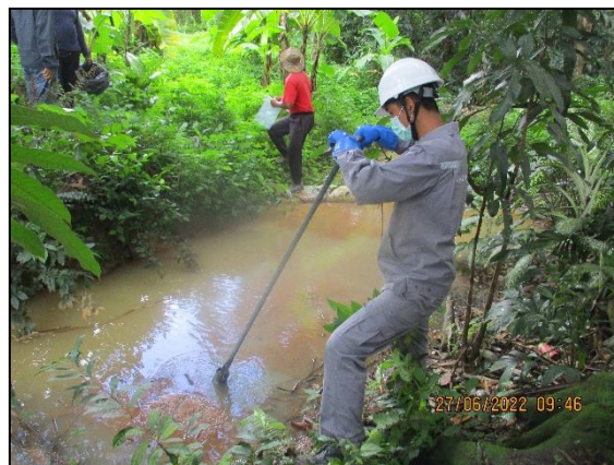
รูปที่ 3.30 การเก็บตัวอย่างโลหะหนักในตะกอนดิน บริเวณคลองควายชุดหลังบ่อจุดระบายน้ำทิ้ง 500 เมตร (SD3) (วันที่ 27 มิถุนายน 2565)
