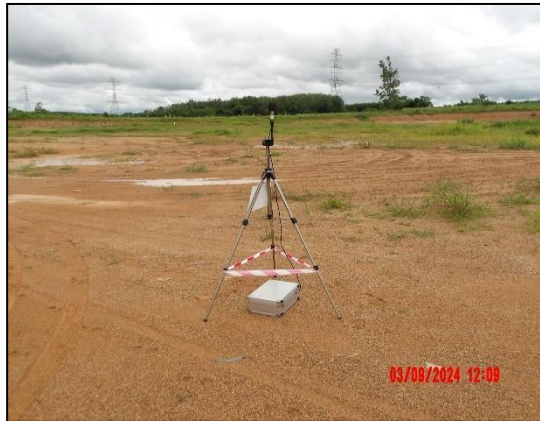
รูปที่ 3.11 ตรวจวัดระดับเสียง 15 นาที บริเวณ เครื่องจักร/เครื่องมือ ซึ่งเป็นแหล่งกำเนิดเสียงในการก่อสร้าง (N7)
