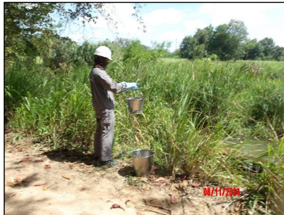
รูปที่ 3.15 การเก็บตัวอย่างคุณภาพน้ำผิวดิน บริเวณคลองควายขุดบ่อหลังบรรจบคลองสาธารณะประโยชน์ (SW4)
